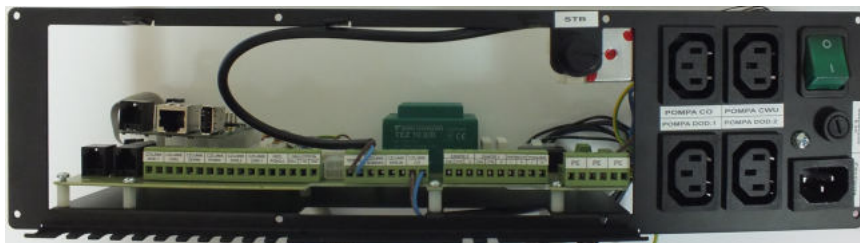
Rysunek 1 Listwa przyłączeniowa do zasilania urządzeń regulacyjnych
