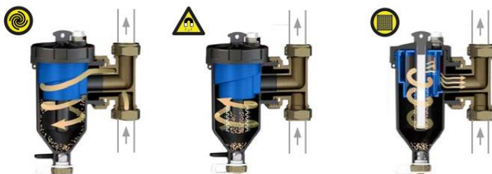
Rysunek 9: Etapy filtracji medium w separatorze ADS 160
