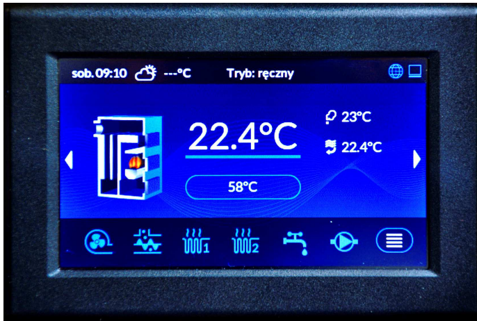
Panel operatorski sterownika
