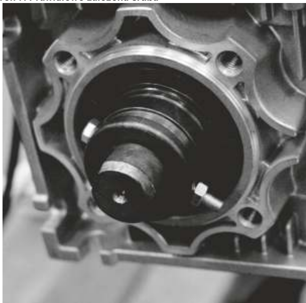
Krok 7. Prawidłowo założona śruba
