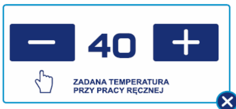
Rysunek 37. Ekran nastawy temperatury obiegu w trybie ręcznym oraz w trybie program bez obniżenia.
