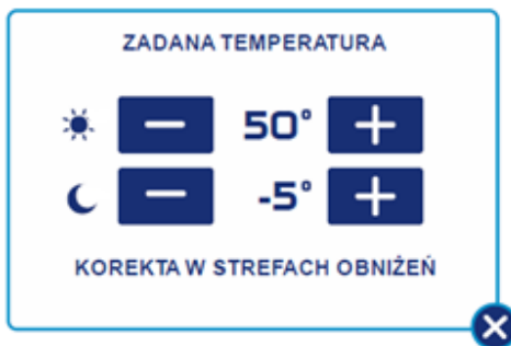
Rysunek 38. Ekran nastawy temperatury obiegu w trybie program zgodnie z harmonogramem lub termostatem.
