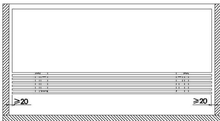
widok z przodu- montaż pionowy
