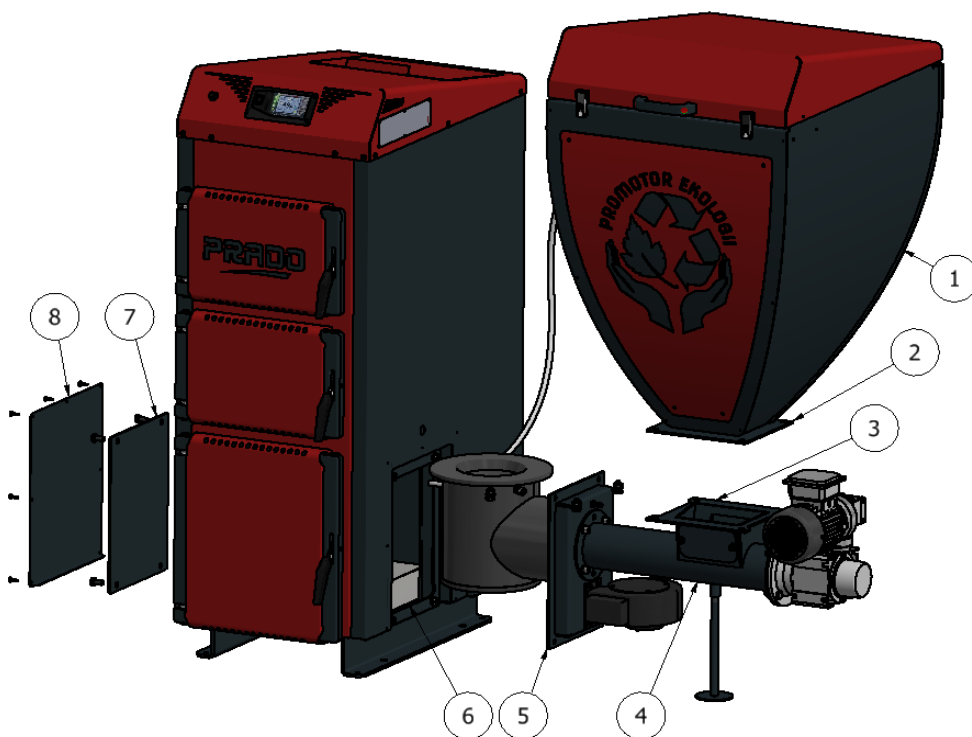
Rys. 12 Przekładanie podajnika na drugą stronę kotła
