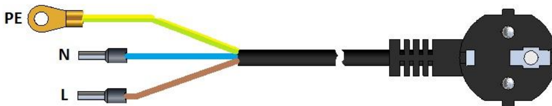
Rysunek 5: Sposób wykonania przewodu zasilającego
